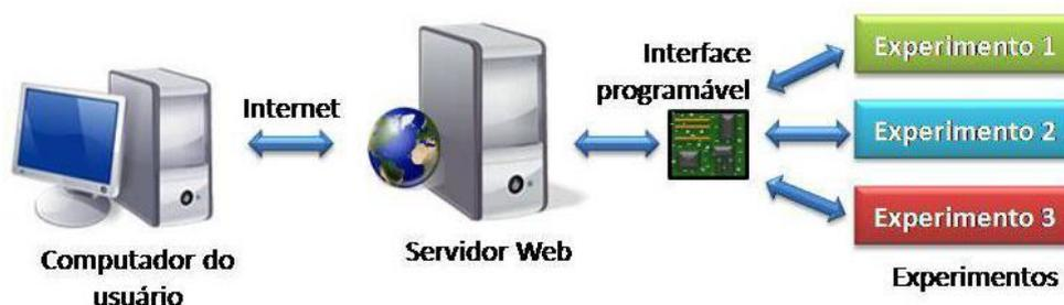
Figura 2 – Esquema de um modelo de Laboratório Remoto (Cardoso e Takahashi, 2011)
